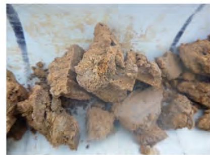
S03 : Détail du sondage avec taches d'oxydation 30-60cm
